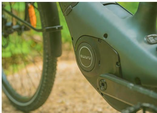
nen Fahrverhalten anpassen soll. Eines aber ist sicher: Hier wird einem in jeder Lebenslage geholfen. Der Mittelmotor mit mit einem Drehmoment von 65 nM und 48 V Lithium-Ionen-Akku ist dafür ausreichend dimensioniert, sowohl längere Strecken als auch mittlere bis moderate Anstiege anzugehen.
